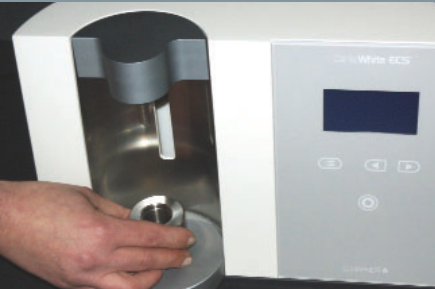
Einsetzen des Schlickertopfes
