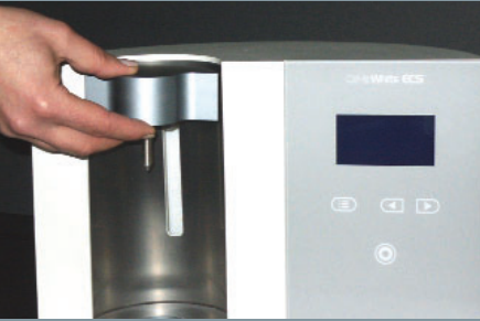
Einsetzen der ECS Elektrodenaufnahme
